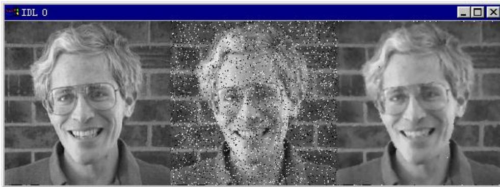
图 37 左边为原始图像, 中间为噪声图像, 右边为用中值滤波器平滑处理后的噪声图像
