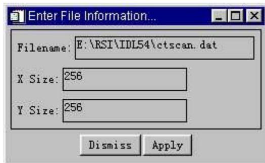
图 91 无阻塞对话框程序 GetFile, 它类似于图 90 的阻塞对话框 GetData。按钮上的文本表明了这是一个无阻塞程序
